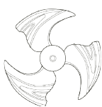
Лопasti с высоким статическим давлением
